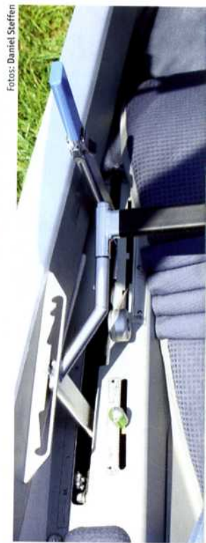
Vier Hebel zur Bedienung der Brems- und Wölbklappen, des Motors und der Trimmung.
