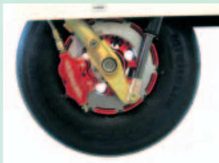
DAS HAUPTTRAD wird elektrohydraulisch eingefahren. Die Scheibenbremse wird über den Bremsklappenhebel betätigt.
