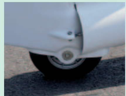
DAS HECKRAD im Seitenruder erleichtert den Start und das zielsichere Ausrollen nach der Landung.
