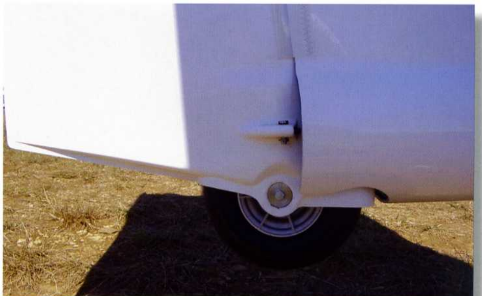
Das Spornrad ist lenkbar und in das Seitenruder integriert
