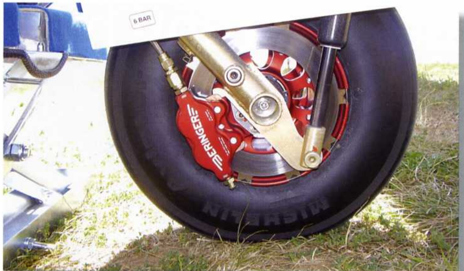
Das große, leichte 5-Zoll-Beringer-Rad ist mit einer hervorragend wirksamen hydraulischen Scheibenbremse ausgestattet
