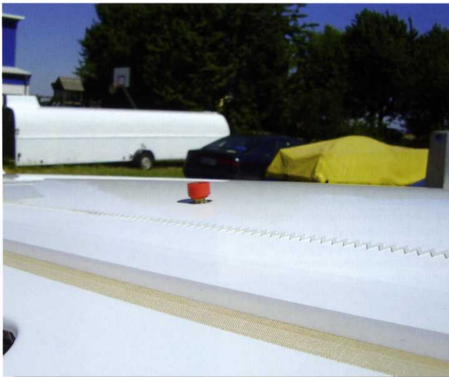
❗ Ist das Höhenleitwerk noch nicht fertig montiert, wird dies vom herausstehenden roten Knopf eindeutig angezeigt
