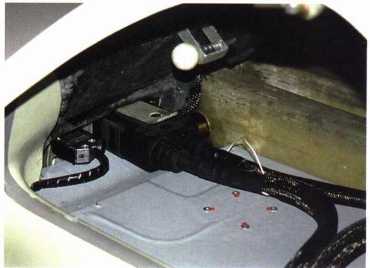
Siiven tyvi. Kuvissa näkyy akun liitin sekä akkujen jäähdytyskanavat.
