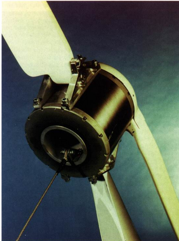
Moottori painaa 28,5 kg ja sen pyörivään ulkokehään on kiinnitetty potkuri.
