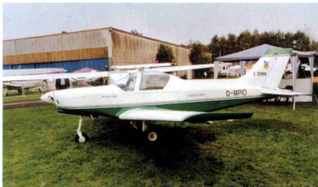
► Klassische Formen aus Italien: Die neue Pioneer 300 hat einen CFK-Rumpf und Flügel aus Holz. Einziehfahrwerk, Klappen und Verstellpropeller des Highspeed-ULs (max. 300 km/h) werden elektrisch bedient. Einführungspreis (inkl. MwSt.): 140 000 DM.
