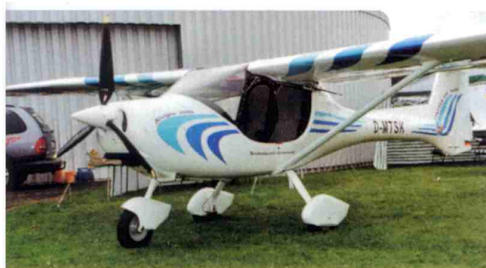
► Zwei Tage vor Messebeginn kam die Zulassung: Mit Detailverbesserungen an Fahrwerk und Motoraufhängung und dank neuem Profil 20 Prozent leistungsfähiger, präsentierte sich die neue Allegro 2000 von Fantasy Air.
