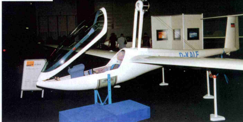
► Der Antares-Erprobungsträger für den Elektroantrieb , eine modifizierte DG-800B. Merkmale des Drehstrommotors sind die feststehende Wicklung innen und drei Wicklungspaare auf dem Spulenkörper, der zugleich die Propellerachse bildet (Außenläuferprinzip).
