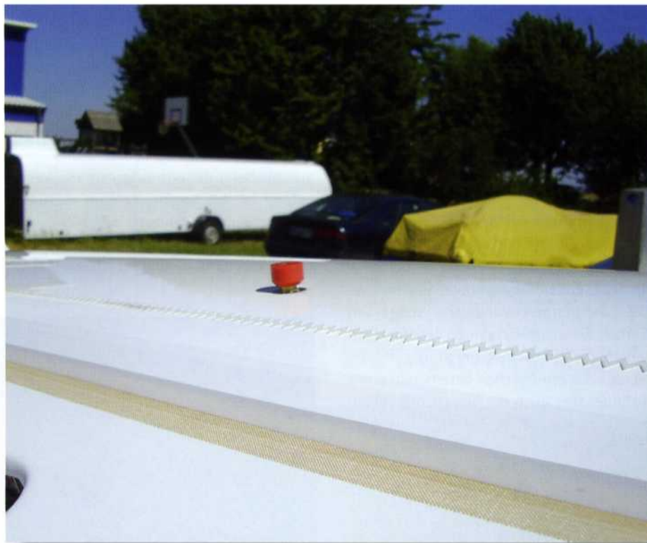
Ist das Höhenleitwerk noch nicht fertig montiert, wird dies vom herausstehenden roten Knopf eindeutig angezeigt
