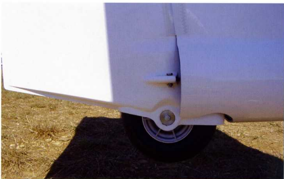
Das Spornrad ist lenkbar und in das Seitenruder integriert
